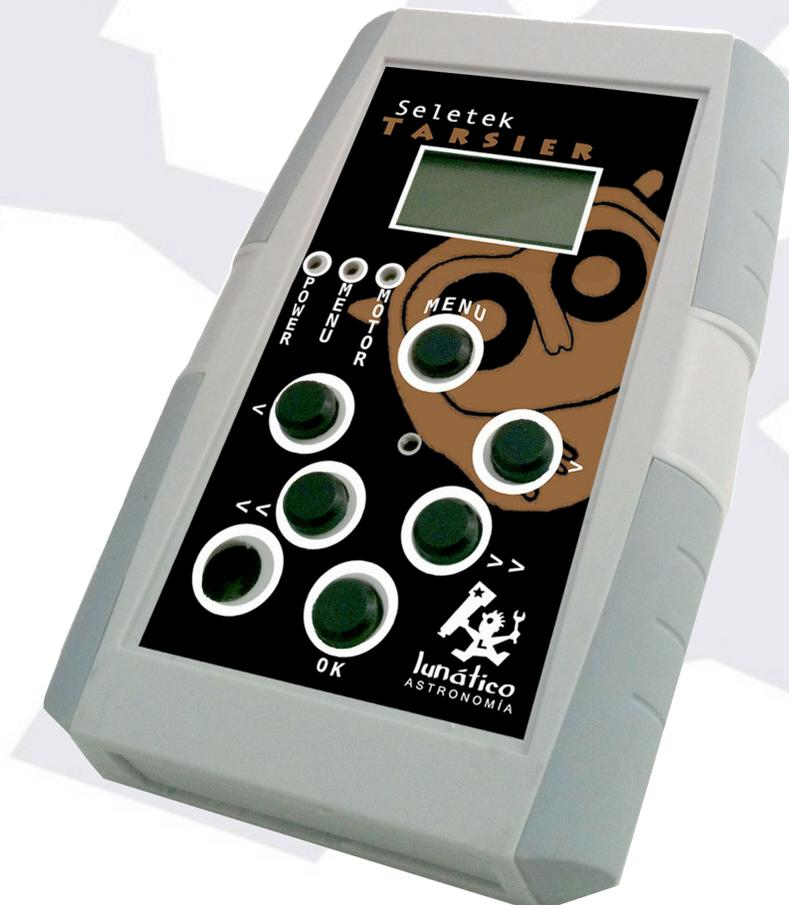
El **Seletek Tarsero** ha sido diseñado para ayudarle en la tarea de enfocar el telescopio, en aquellas ocasiones en que no se desea o no se puede utilizar un ordenador.
