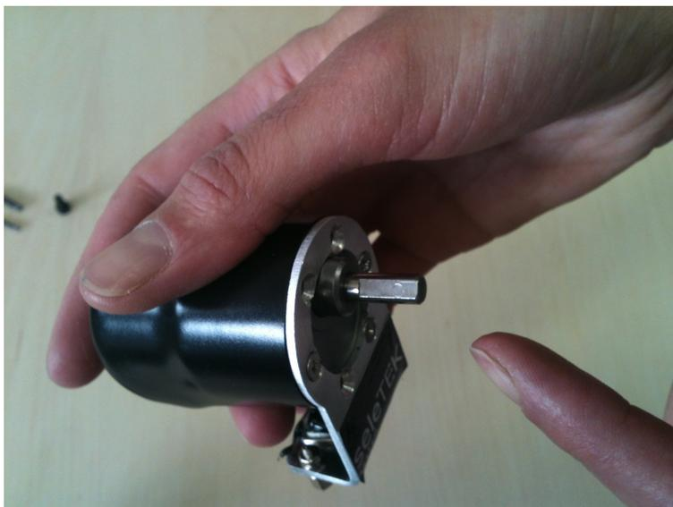
**ATENCIÓN:** El eje del motor no se puede mover a mano, por ello deberá conectarlo al Seletek para realizar esta alineación.<sup>2</sup>
